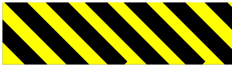
Figura 1. Ejemplo de combinación de color de seguridad (amarillo) y color de contraste (negro)
